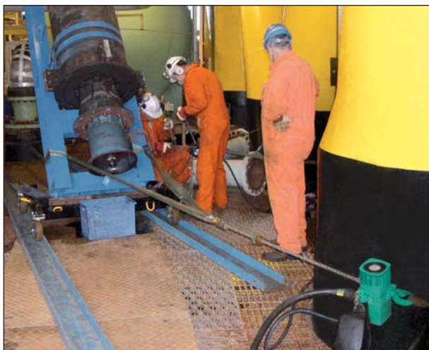
JDN-Druckluft-Hebezug mini 1000 beim Handling einer Ölpumpe.
