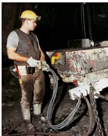
Пневматический подъемник JDN, освобождающий застрявший погрузчик.
