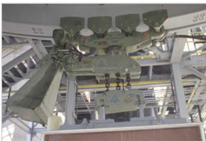
Kurvengängiges EH 80 beim Einsatz in der Zement-Industrie.
