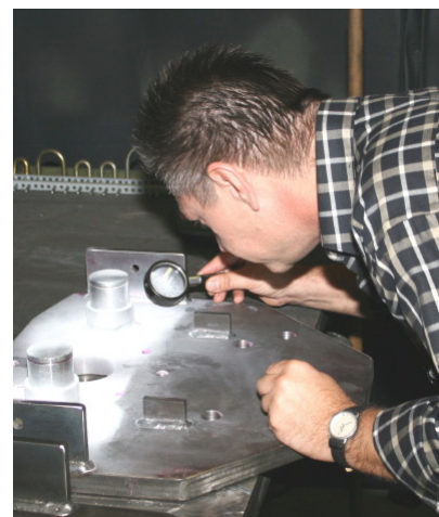
JDN-Schweißfach-Ingenieur Jürgen Kewitz beim Begutachten eines geschweißten Laufkatzen-Blechtes.
