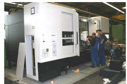
Zur Zeit sind Techniker der Herstellerfirma dabei, die Maschine einzurichten.
