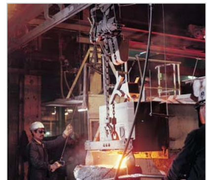
Unempfindlich gegen Staub und Hitze: JDN-Druckluft-Hebezüge der Profi-Serie.
